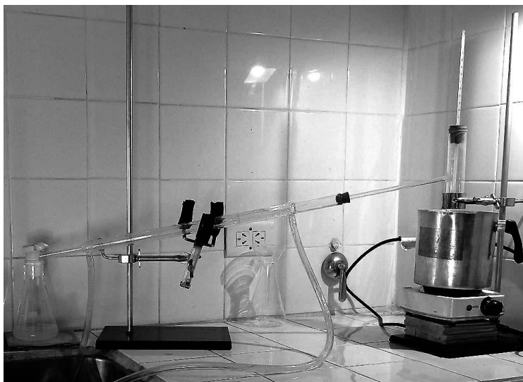
Sistema destilador de laboratorio calefaccionado mediante baño María
