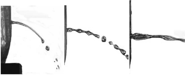
Flujos laminar, transición y turbulento (agua).
