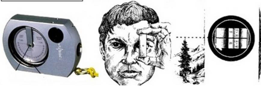
Para acelerar el tiempo de medición y evitar que éste sea un impedimento, se han inventado muchos instrumentos (regla telescópica, el hipsómetro, el nivel de Abney o clisímetro, y el clinómetro, entre otros). Hoy en día es posible medir la altura a partir de una distancia fija del árbol y, de esta manera, se pueden facilitar los cálculos. Existen clinómetros que pueden efectuar mediciones a distancias fijas de 15 y 20 m, aunque también se pueden hacer con diferentes distancias.
