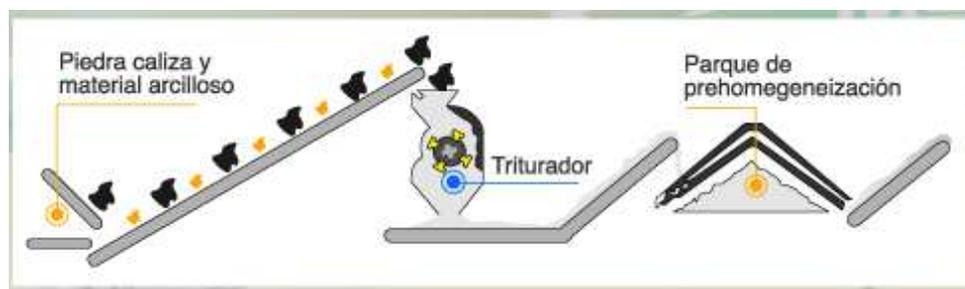
La prehomogeneización permite preparar la dosificación adecuada de los distintos componentes. El material se muele en molinos para favorecer su cocción al horno y se almacena en un silo
