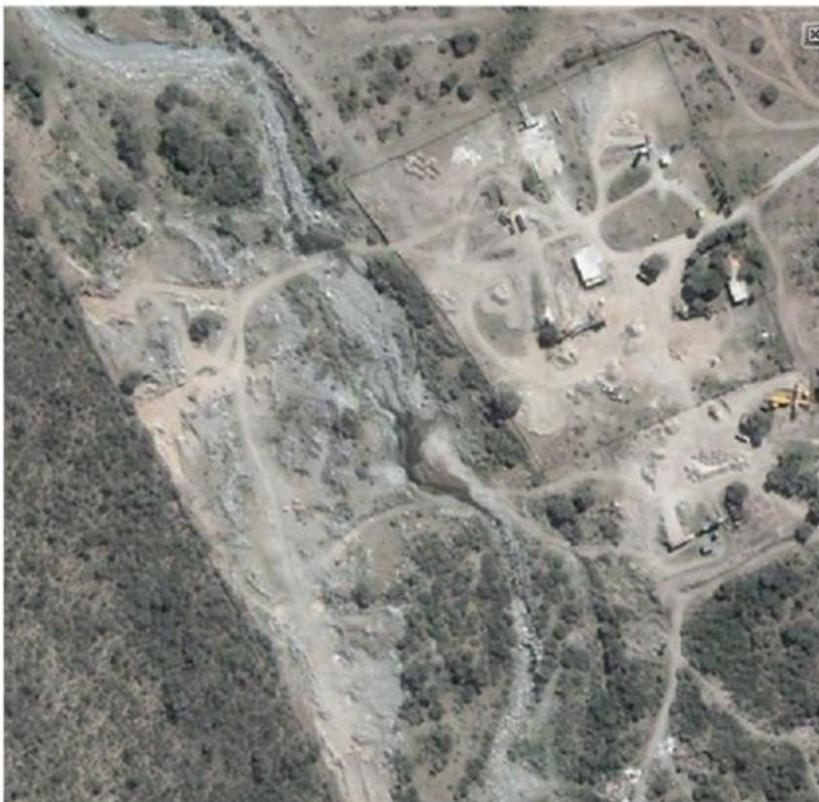
**Foto 3.** Recorte de una imagen Google Earth, donde se muestra la cantera de áridos explotada por la Municipalidad de la Capital y su planta clasificadora de áridos.
