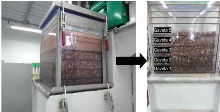
Figura 2. Jigue utilizado no programa de testes.
