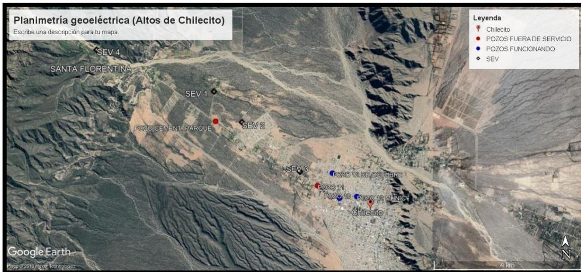
**Figura 8.4 Geoelectrica Altos de Chilecito. Reformulación de los trabajos de Conhidro (2009). Se adiciona la perforación 12 de Octubre, actualmente en funcionamiento al noroeste de la ciudad de Chilecito. En rojo Pozo 11 que a escasos 400 al oeste no se concluye pozo emprendido por Geogrup. También en rojo se consigna (entre sev 1 y sev 2) el fracaso de los trabajos del pozo denominado “Cementerio Parque”.**
