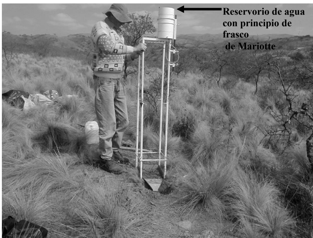
Foto 2: Reservorio de agua con principio de frasco de Mariotte
